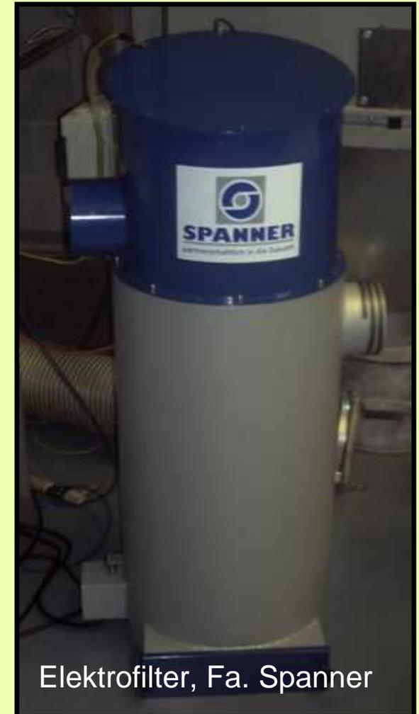
Elektrofilter, Fa. Spanner
